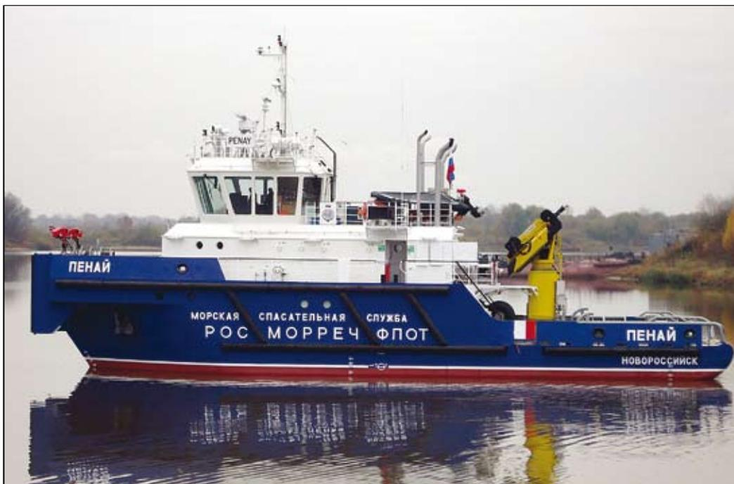
**Основные характеристики судна проекта TG17:** Водоизмещение полное 558 т, порожнем 407 т. Дедвейт 151 т. Длина габаритная 31,73 м, по ВЛ 28,74 м. Ширина габаритная 9,73 м, по КВЛ 9,1 м. Высота борта 4,10 м. Осадка по ЛГВЛ 3,1 м. Скорость 11,4 узла. Экономическая скорость 8,0 узлов. Автономность 10 суток. Экипаж судна 7 человек, общее количество мест на судне 12.
